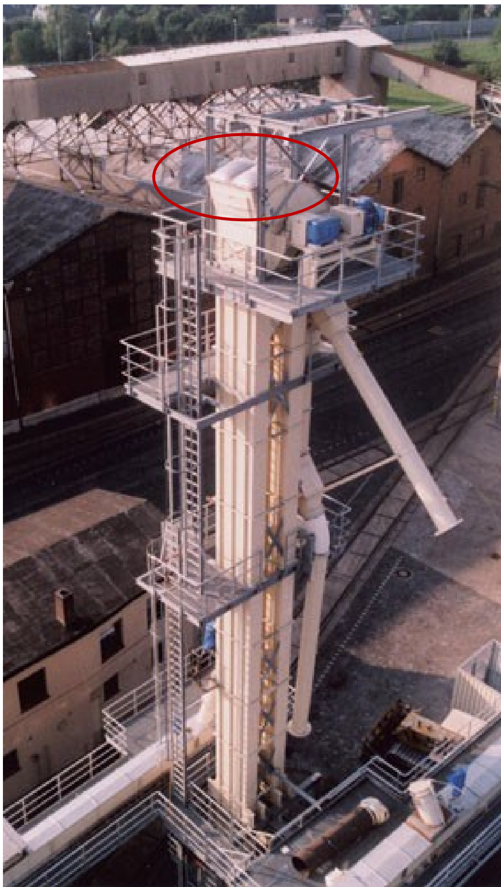
Ventana de venteo en el extremo superior del elevador
